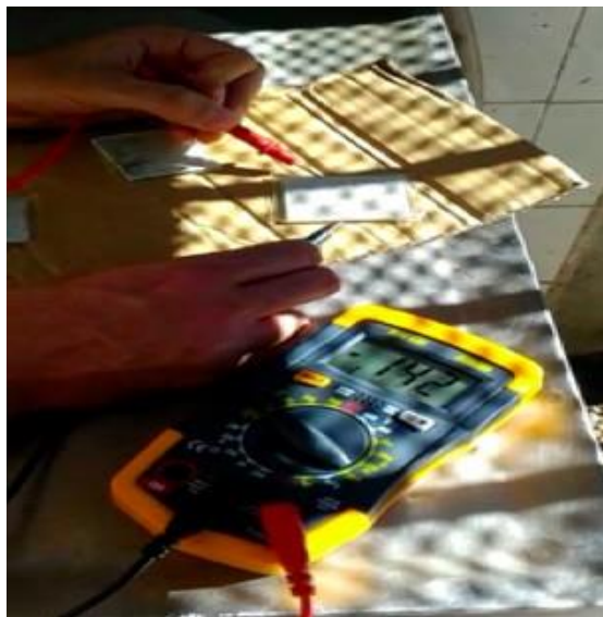
Figura 11. Célula de Açai gerando 142 mV
