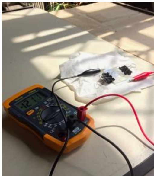
Figura 12. Célula de Açáí com Clorofila gerando 121 mV
