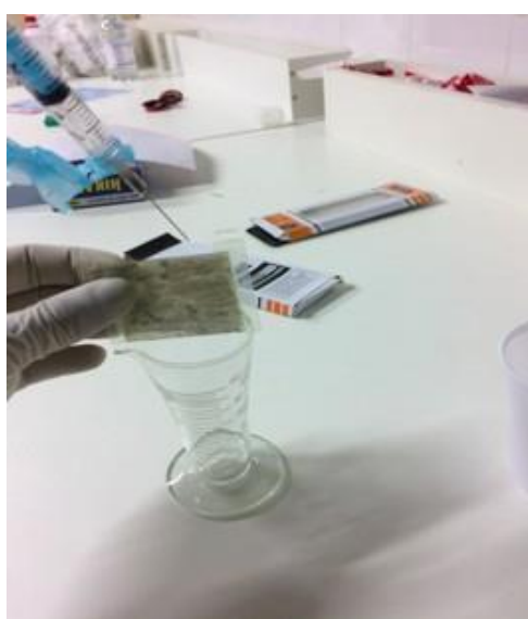
Figura 9. Deposição do eletrólito por capilaridade
