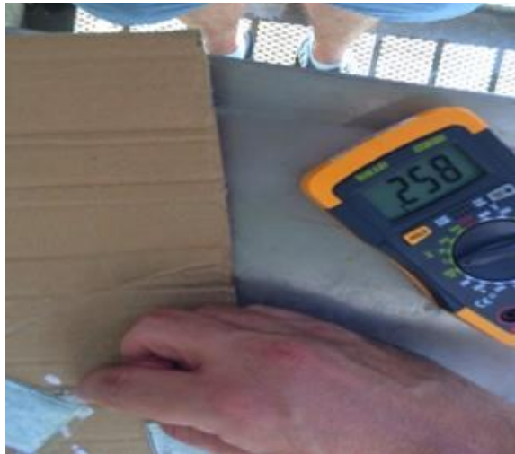
Figura 10. Célula de Clorofila gerando 258 mV
